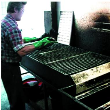
Bisher wurden die Schilder 12 Stunden lang in einem Mehrkammerbad (AII-Lösemittel) eingeweicht, mechanisch bearbeitet und in einer kleinen Durchlaufanlage (AIII-Produkt) gereinigt. Abschließend wurde die Oberfläche mit Butyldiglykol fettfrei gewaschen und mit Wasser gespült.
