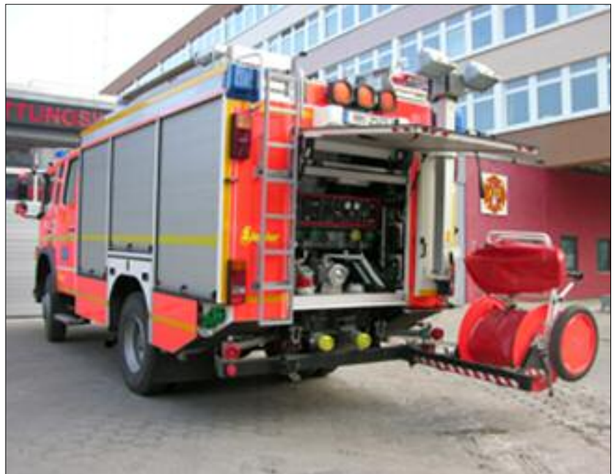
Der Geräteraum – mit geöffneter Klappe (oben). Rechts der G1 – die Ausstattung auf dem neuesten Stand der Technik
