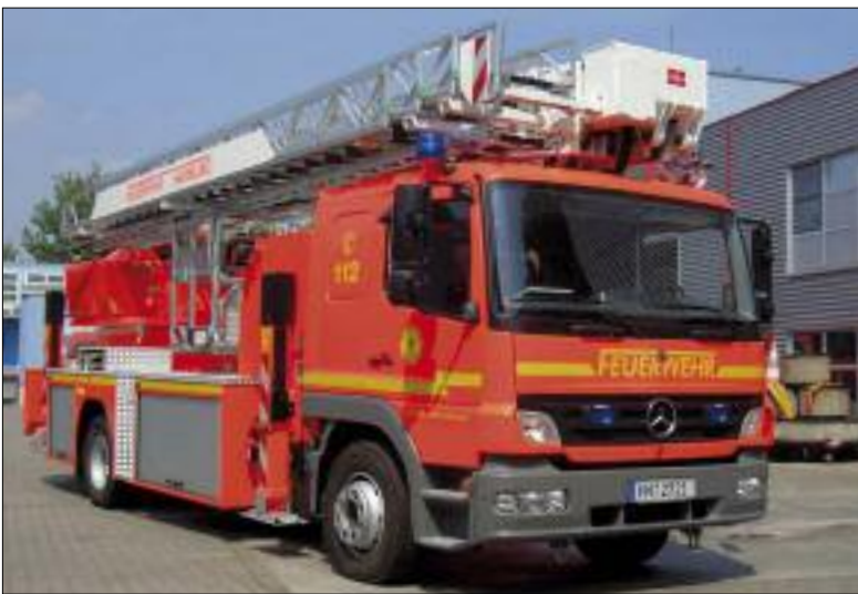
Die Hubrettungsfahrzeuge der Hamburger Feuerwehr: das TMF Bronto Skylift TLK 23/12 ...
