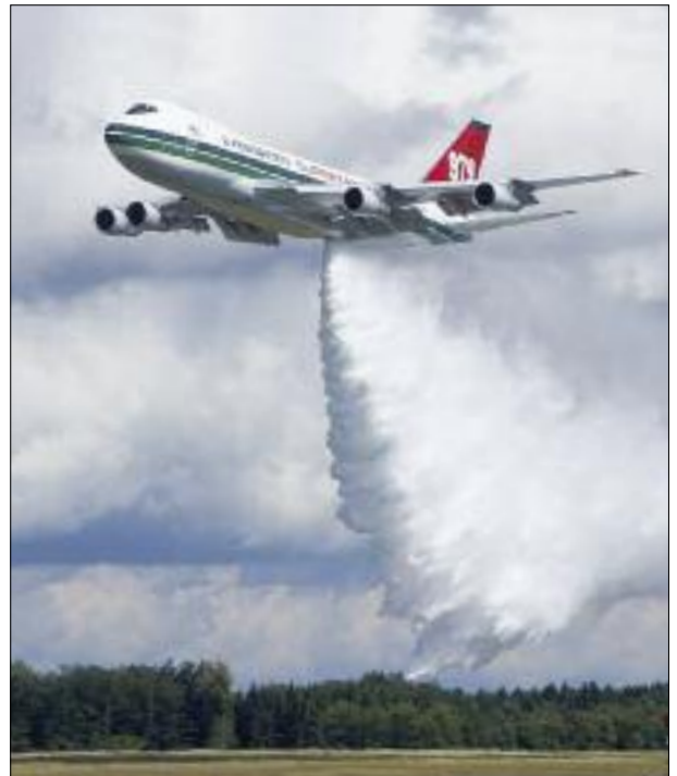
Das größte Löschflugzeug der Welt: Die Boeing 747 kann 77.600 Liter Löschflüssigkeit aufnehmen
