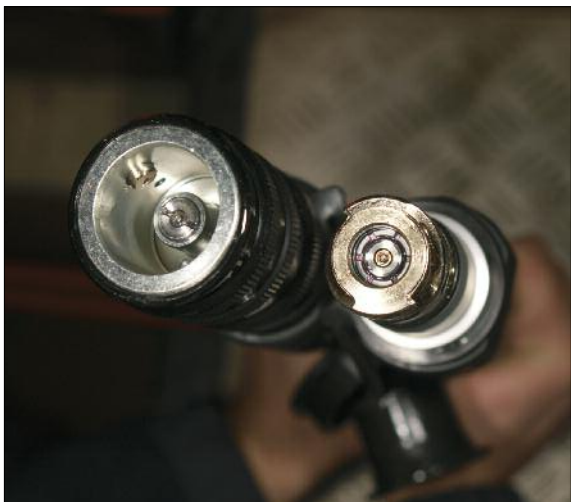
Leichtere Bedienung: die Weber-Bajonett-Kupplung
