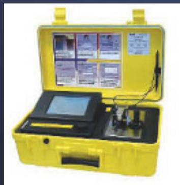
bestimmten Wellenlänge ein Teil dieser Energie absorbiert. Dieser Energieverlust lässt individuelle „Spektrale“ entstehen, die mit denen der Datenbank verglichen werden. Die Spektren mit der größten Übereinstimmung werden dann von dem HazMatID angezeigt.
