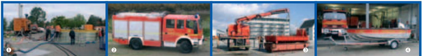
1 Separationsanlage Sepcon 01 2 Gerätekraftwagen 3 Gerätewagen Kran (inkl. Atlas-Heckladekran mit 5 t (Hebekraft) 4 Aluminium-Kleinboot (Typ II)
