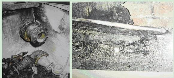
Brandtrichter im Bereich einer abgerissenen Gasleitung (links) und Brandzehrung an einer Holzleiste (rechts)
