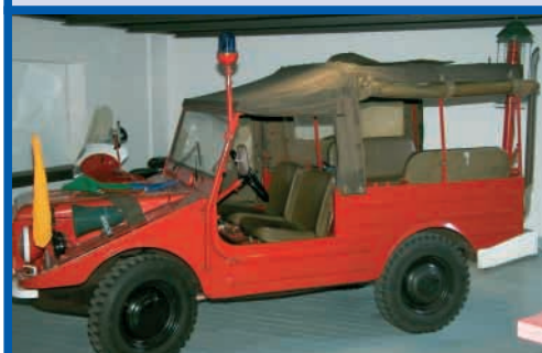
Der DKW Munga 8 (er kann 8 Personen befördern) wurde auch als FuKW (Funkkommandowagen) bezeichnet. Er diente als mobile Funkstation mit einer ausfahrbaren 7-Meter-Antenne sowie als Fahrzeug des Einsatzleiters und „Botenjunge“. Die letzten seiner Art waren bis Mitte der 80er Jahre „im Dienst“ – damals jedoch nur noch als Fahrschulfahrzeuge, u.a. an der LFS in Billbrook.
