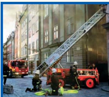
Wechselladerfahrzeug mit Spezialdrehleiter für Einsätze in den engen Gassen Stockholms.
