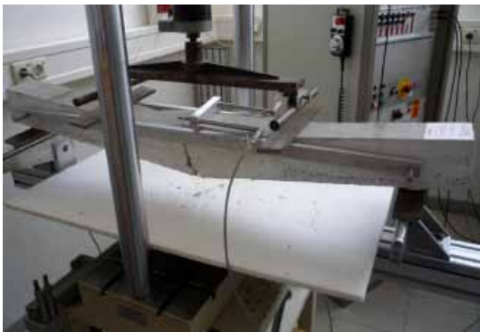
4-Punkt Biegezugversuch, Quelle: ILEK
