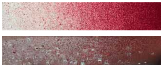
oben: Glasfasergewebe mit Silikonverlauf zur Gradierung der Permeabilität
