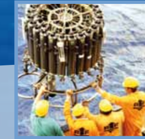
Ein Kranwasserschöpfer des Leibniz-Instituts für Meereswissenschaften IFM-GEOMAR wird zu Wasser gelassen.
