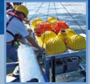
Ausbringen eines chemisch inerten Spurenstoffs mit dem Ocean Tracer Injection System.
