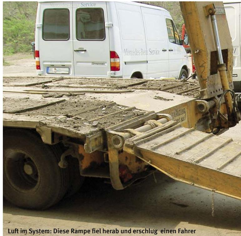
Luft im System: Diese Rampe fiel herab und erschlug einen Fahrer
