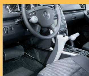
Eine Handsteuerung mit Fußabdeckung, eingebaut in eine Mercedes B-Klasse.
