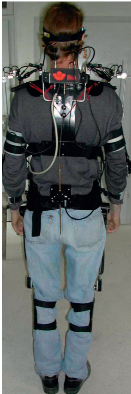
Von Kopf bis Fuß verkabelt. Die Sensoren des computerunterstützten Messsystems CUELA liefern kontinuierlich Daten, wie stark Schulter- und Armgelenke, Knie- und Hüftgelenke gebeugt werden und welche Position die Wirbelsäule im Brust- und Lendenwirbelbereich einnimmt. Die Daten werden mit den Aufnahmen einer Video-Kamera abgeglichen.
