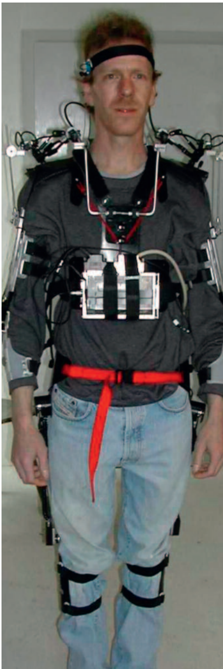
Von Kopf bis Fuß verkabelt. Die Sensoren des computerunterstützten Messsystems CUELA liefern kontinuierlich Daten, wie stark Schulter- und Armgelenke, Knie- und Hüftgelenke gebeugt werden und welche Position die Wirbelsäule im Brust- und Lendenwirbelbereich einnimmt. Die Daten werden mit den Aufnahmen einer Video-Kamera abgeglichen.
