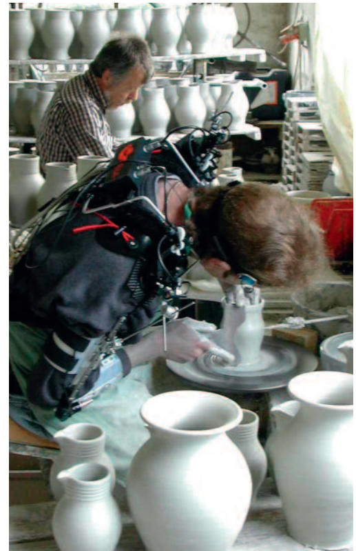
Von Kopf bis Fuß verkabelt. Die Sensoren des computerunterstützten Messsystems CUELA liefern kontinuierlich Daten, wie stark Schulter- und Armgelenke, Knie- und Hüftgelenke gebeugt werden und welche Position die Wirbelsäule im Brust- und Lendenwirbelbereich einnimmt. Die Daten werden mit den Aufnahmen einer Video-Kamera abgeglichen.
