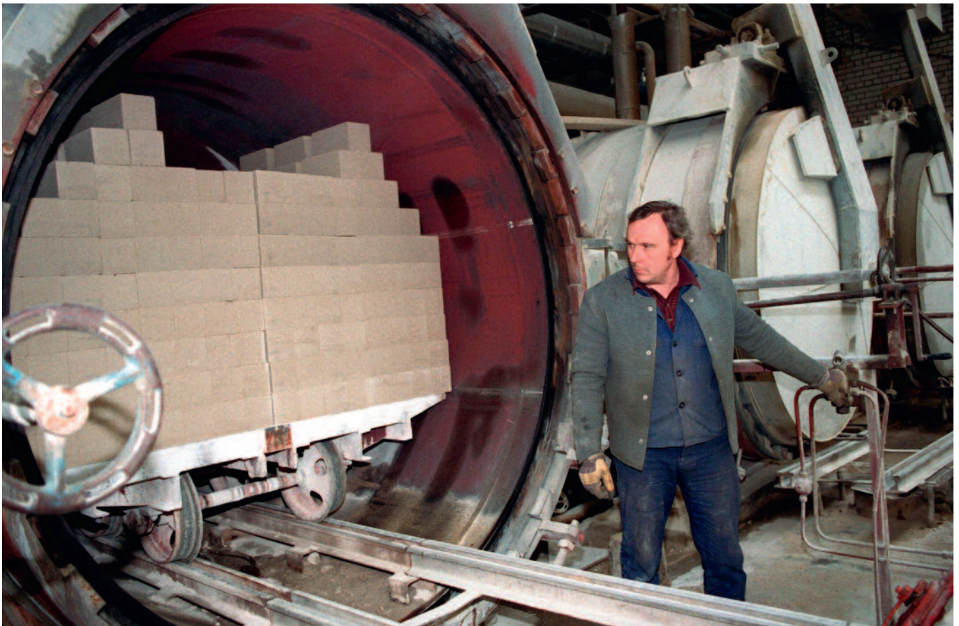
Vorbereitung für die nächste Härtung. Ein Mitarbeiter beschickt einen Steinhärtekessel mit Rohlingen.
