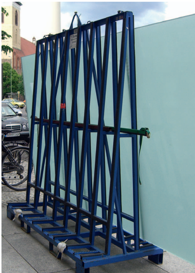
Sicherheit beim Glastransport: Auf einem korrekt benutzten Flachglas-Transportgestell sind Glasauflagen gegen das Verrutschen geschützt.
