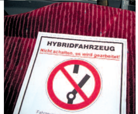
Die elektrische Anlage darf nur von Mitarbeitern wieder eingeschaltet werden, die gemäß Stufe 2 qualifiziert werden. Bei Instandhaltungsmaßnahmen sollte das Aus- und Wiedereinschalten durch dieselbe Person erfolgen.
