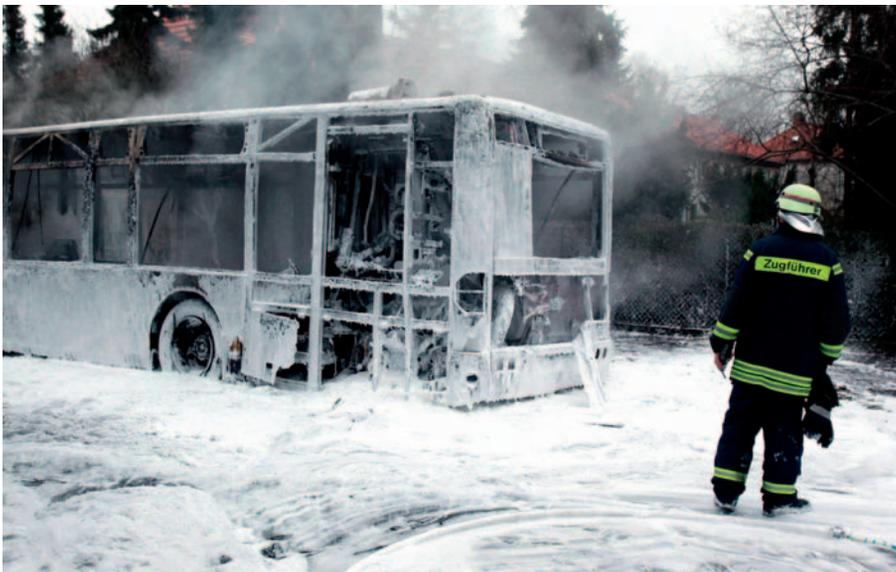
*Bis die Feuerwehr eintrifft, haben sich Motorbrände oft schon auf den ganzen Bus ausgebreitet. Motorraumlöschanlagen können das verhindern.*
