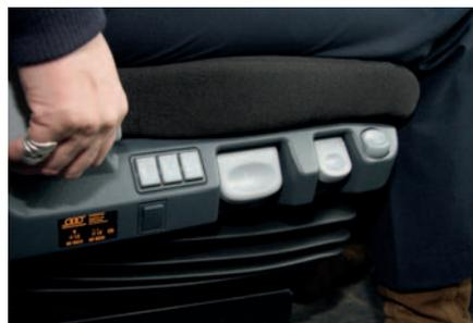
Die komplexen Einstellmöglichkeiten eines hochwertigen Fahrersitzes ermöglichen es, den Sitz optimal einzustellen. Dafür wird aber Zeit benötigt – die in der Praxis oft nicht zur Verfügung steht.
