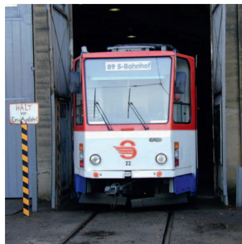
Beim Ein- und Ausfahren besteht an den Torstützen Unfallgefahr durch Quetschen.
