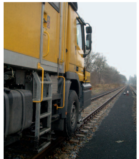
Die EN 15746-1 regelt auch die Gestaltung der Aufstiege an Zwei-Wege-Fahrzeugen.
