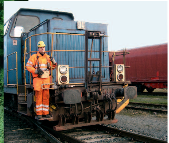
Lokrangierführer sind auf Mitfahrerständen vor allem Lärmbelastungen durch Fahrgeräusche der Lok ausgesetzt.
