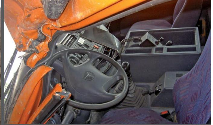
Als der Fahrer an der Kante der Halde sieben Tonnen Bauschutt aus der Mulde abkippen wollte, überschlug sich das Fahrzeug und stürzte den Hang hinab.
