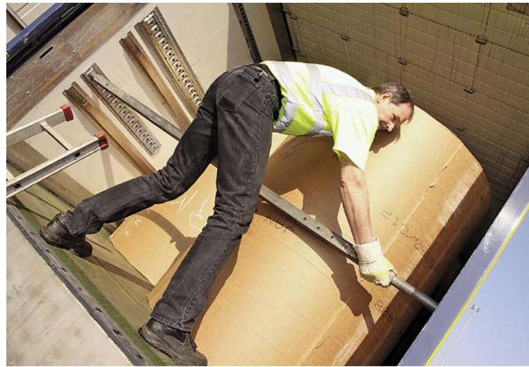
**Abschluss:** Harald Dreyer befestigt nach dem Sichern mit dem Gurt mit wenigen Handgriffen den Sperrbalken am Ende der Ladefläche
