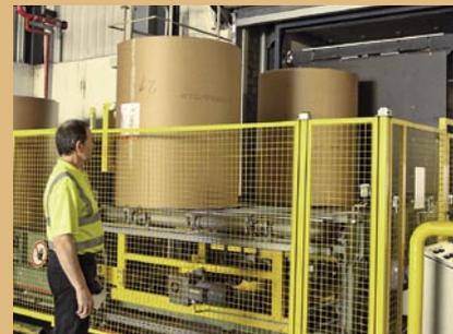
Optimum an Ladungsschutz. Die in die Koffer integrierte Technik erleichtert den Fahrern zudem die Arbeit: Die Rollen werden nämlich senkrecht befördert. Sobald der Gabelstaplerfahrer die Rolle auf die Ladefläche – sprich: das Gurtband – gesetzt hat, lässt der Fahrer das tonnenschwere Ladungsteil per Fernsteuerung nach vorne zur Stirnwand ziehen. Die Stromversorgung des Gurtband-Motors erfolgt über einen externen Anschluss, anders wäre die Bordbatterie im Nu „leergelutscht“.
