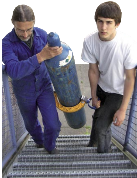
Der Gasflaschengreifer hilft beim Anheben und Tragen schwerer Druckgasflaschen
