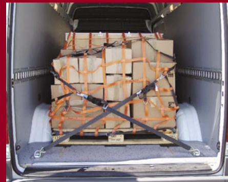
Ladungssicherungsnetz im Einsatzf
