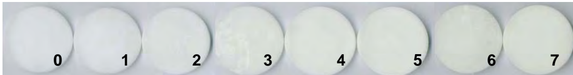
Abbildung 183: Farbveränderung des Tränkwachses bei ansteigender Zyklenzahl von 0 bis 7 unter Verwendung von Fichtenprüfkörpern
