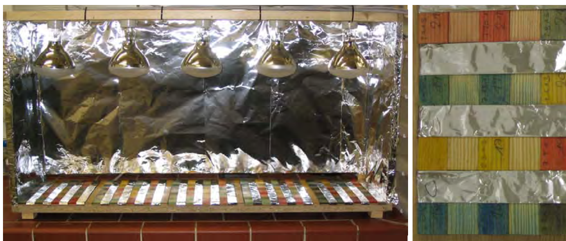
Abbildung 9: Links: Versuchsaufbau der künstlichen UV-Bestrahlung mit Ultra-Vitalux Lampen; Rechts: Häftig mit Aluminium-Folie abgedeckte Prüfkörper
