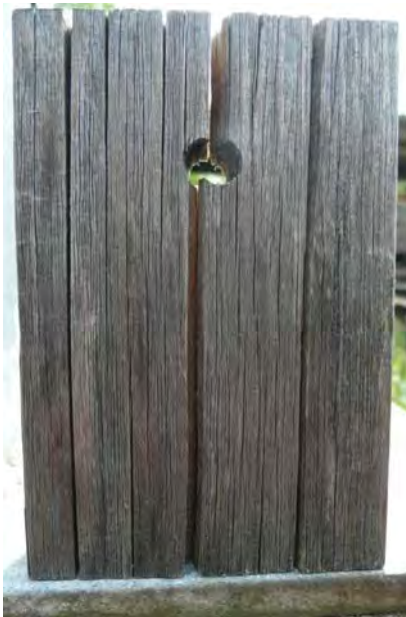
Abbildung 169: Totalausfall des Fichtenprüfkörpers F 46 infolge extremer Rissbildung – Decklage: Frontansicht (links); Rückseite (rechts)
