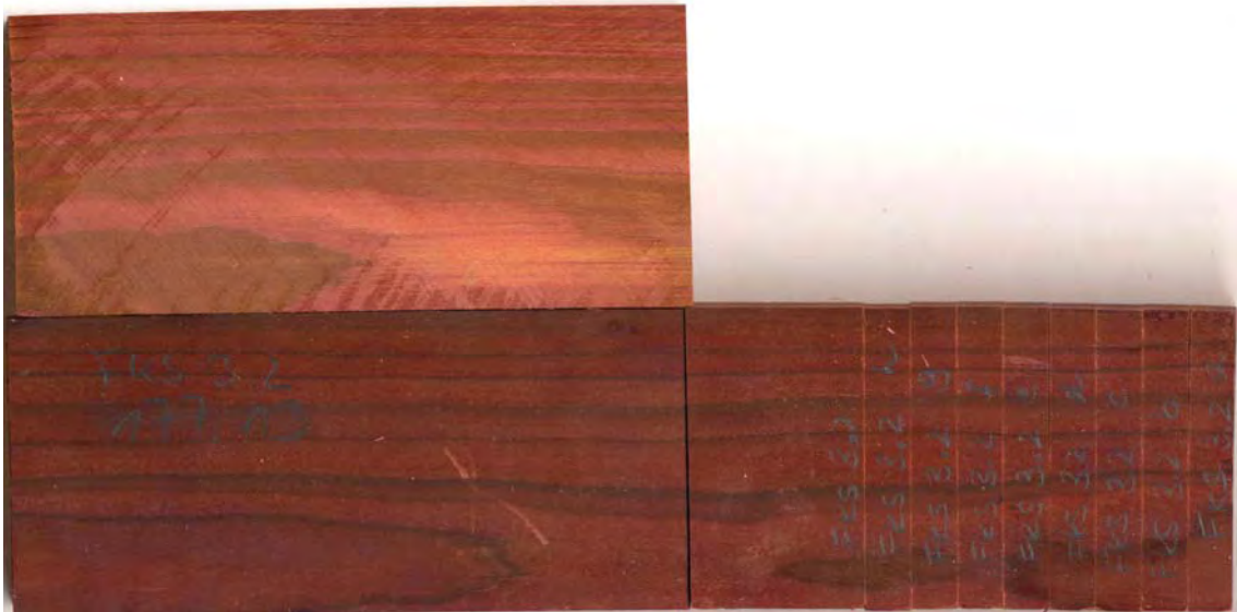
Abbildung 98: Hitzebehandelter Fichten-Prüfkörper der BFH (Fichte-CZ/A) nach Paraffin-Vollzell-Tränkung; Prüfkörper ist vollständig durchfärbt
