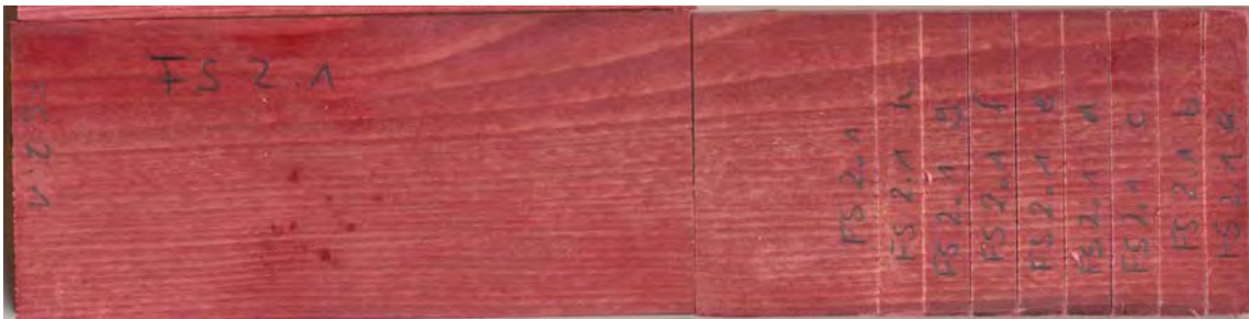
Abbildung 109: Fichten-Prüfkörper der BFH (Fichte-Walsrode) nach Paraffin-Vollzell-Tränkung; Prüfkörper ist unvollständig durchfärbt
