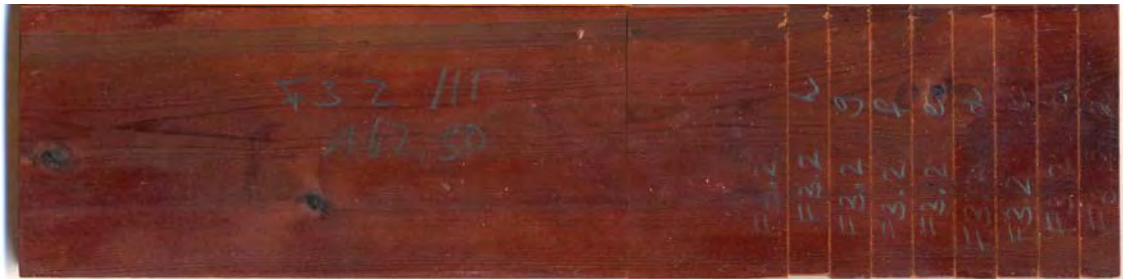
Abbildung 88: Hitzebehandelter Fichten-Prüfkörper der Steinbrügge & Berninghausen GmbH nach Paraffin-Vollzell-Tränkung; Prüfkörper ist unvollständig durchfärbt
