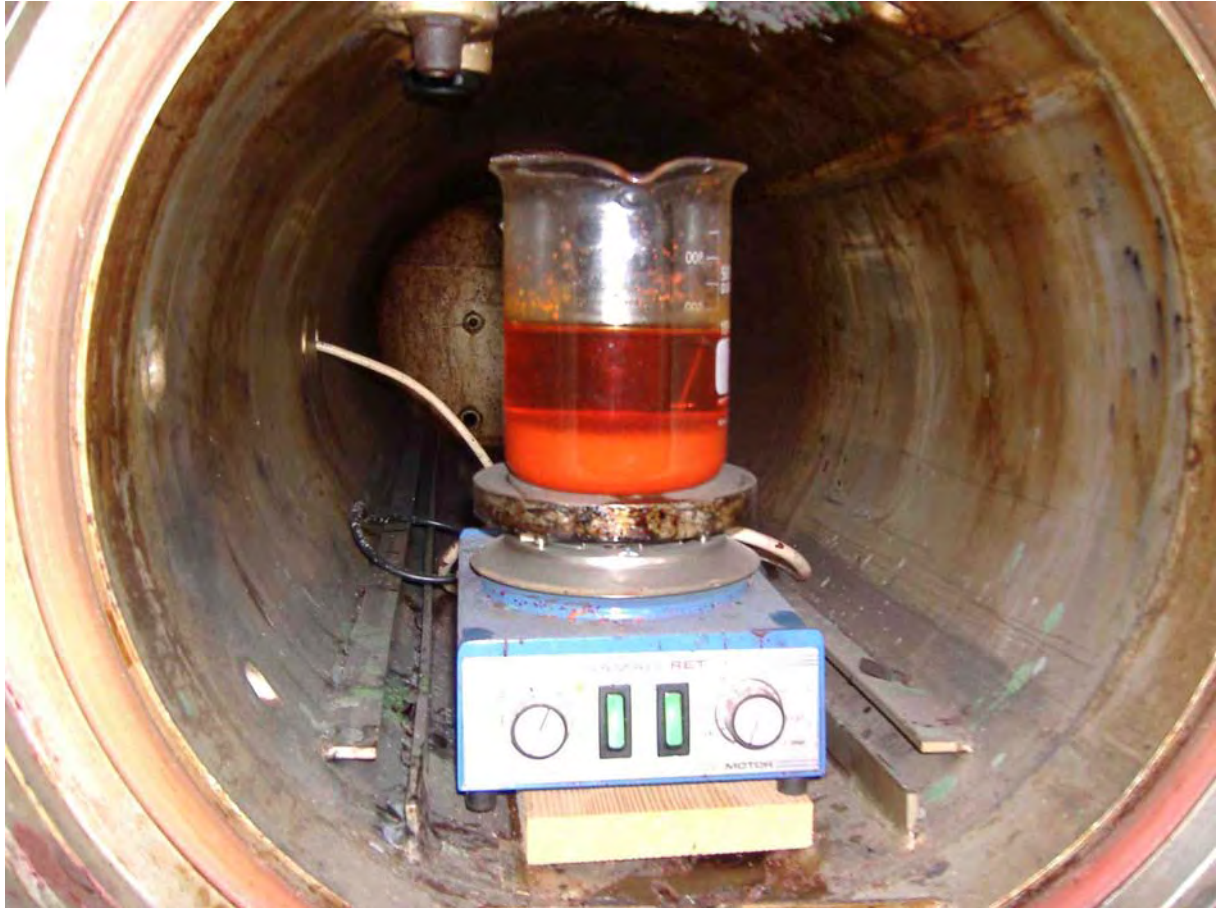
Abbildung 157: Während der Tränkung beobachtetes Absetzen des Farbstoffes „Kelly Plasol 29 Orange“
