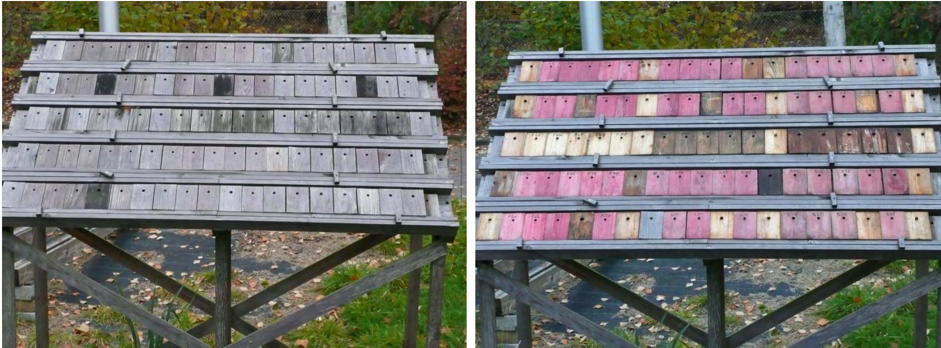
Abbildung 163: Versuchsproben im November 2008 nach 27 Monaten Bewitterungsdauer – Oberseite (linkes Bild) und Unterseite (rechtes Bild) der Decklage
