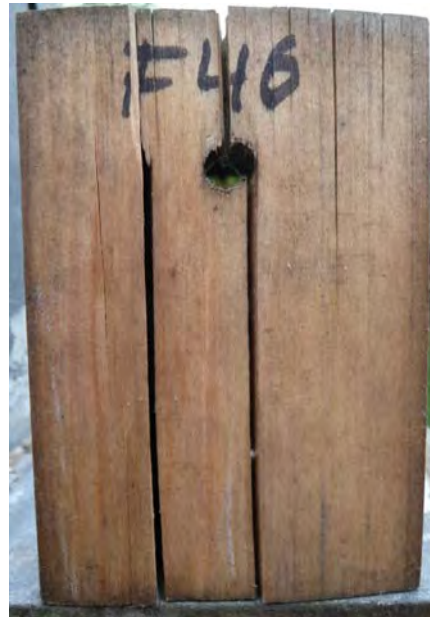
Abbildung 169: Totalausfall des Fichtenprüfkörpers F 46 infolge extremer Rissbildung – Decklage: Frontansicht (links); Rückseite (rechts)
