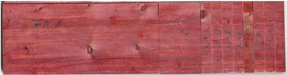
Abbildung 82: Fichten-Prüfkörper der Steinbrügge & Berninghausen GmbH nach Paraffin-Vollzell-Tränkung; Prüfkörper ist unvollständig durchfärbt
