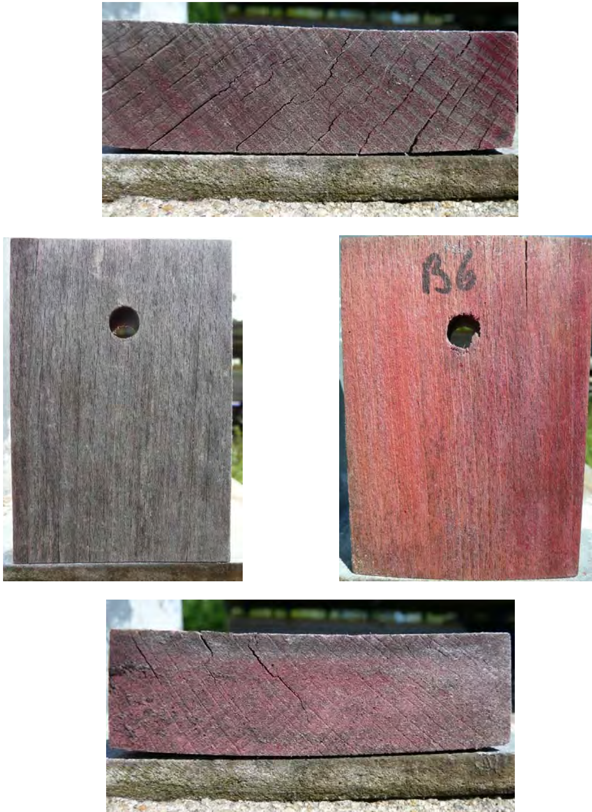
Abbildung 166: Wachsbehandelter Buchenprüfkörper B6 nach 3 Jahren Exposition – Decklage, oberes Bild: Hirnfläche - Kopf, Mitte links: Frontseite, Mitte rechts: Rückseite, unteres Bild: Hirnfläche – Fuß
