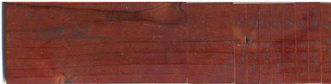
Abbildung 123: Hitzebehandelter Fichten-Prüfkörper der BFH (Fichte-Walsrode-Kern) nach Paraffin-Vollzell-Tränkung; Prüfkörper ist unvollständig durchfärbt
