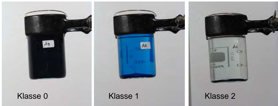
Abbildung 3: Beispielhafte Darstellung der in Tab. 7 gelisteten Klassen des Absetzverhaltens von Pigmenten in Paraffin nach 24h
