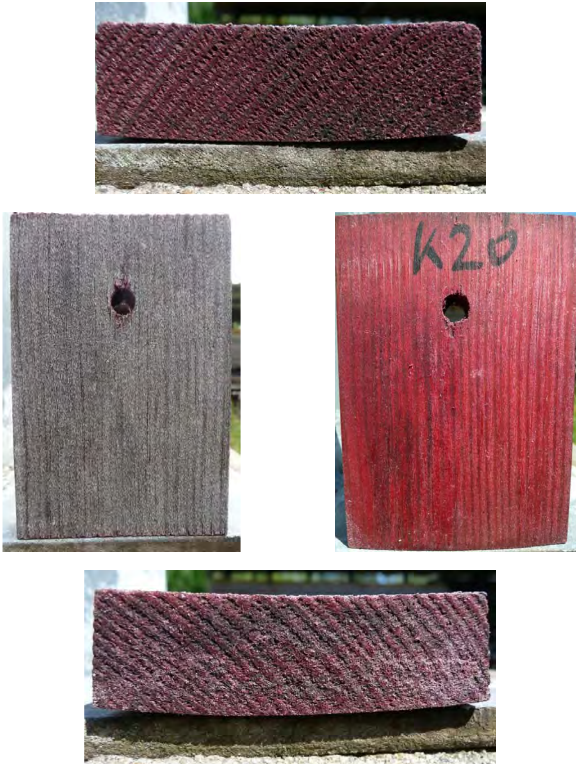
Abbildung 173: Wachsbehandelter Kiefernprüfkörper K20 nach 3 Jahren Exposition – Decklage; oberes Bild: Hirnfläche - Kopf, Mitte links: Frontseite, Mitte rechts: Rückseite, unteres Bild: Hirnfläche – Fuß
