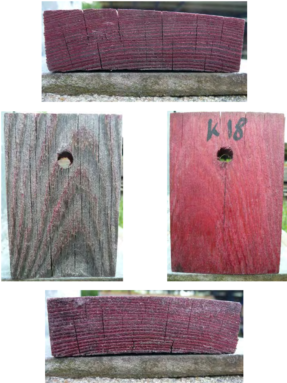
Abbildung 175: Gerissener, wachsbehandelter Kiefernprüfkörper K18 nach 3 Jahren Exposition – Decklage; oberes Bild: Hirnfläche - Kopf, Mitte links: Frontseite, Mitte rechts: Rückseite, unteres Bild: Hirnfläche – Fuß
