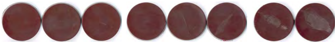
Abbildung 185: Farbveränderung des gefärbten Tränkwaxes bei ansteigender Zyklenzahl von 0 bis 7 (von links nach rechts) unter Verwendung von Kiefernprüfkörpern
