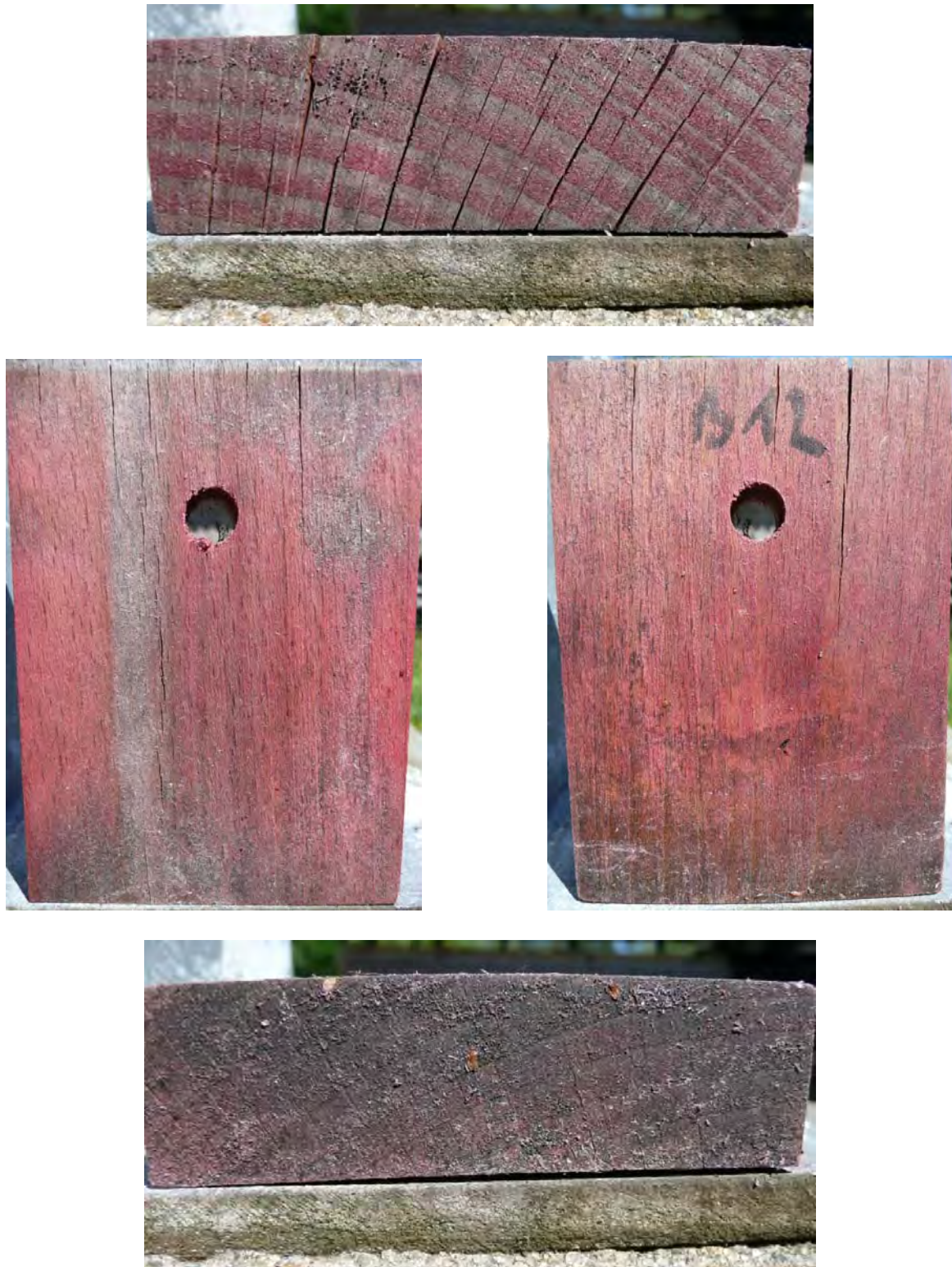
Abbildung 167: Wachsbehandelter Buchenprüfkörper B12 nach 3 Jahren Exposition – Unterlage; oberes Bild: Hirnfläche - Kopf, Mitte links: Frontseite, Mitte rechts: Rückseite, unteres Bild: Hirnfläche – Fuß
