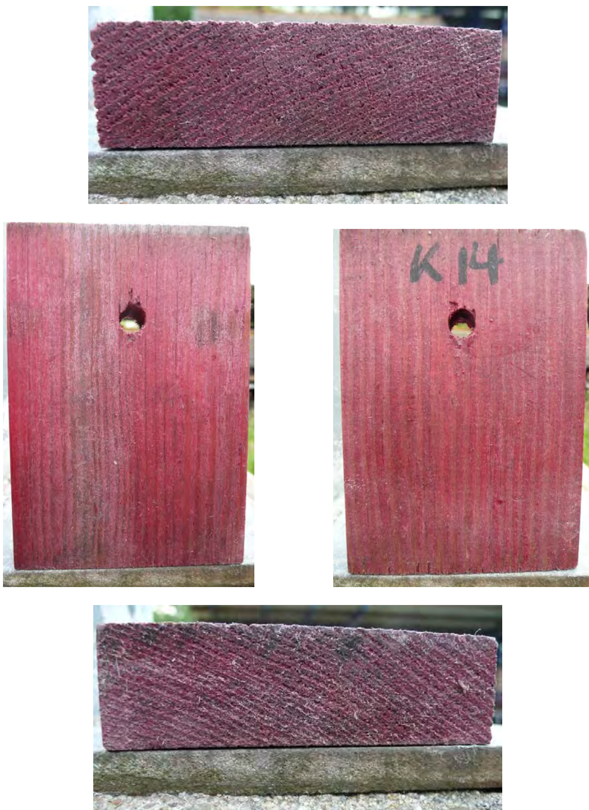
Abbildung 174: Wachsbehandelter Kiefernprüfkörper K14 nach 3 Jahren Exposition – Unterlage; oberes Bild: Hirnfläche - Kopf, Mitte links: Frontseite, Mitte rechts: Rückseite, unteres Bild: Hirnfläche – Fuß
