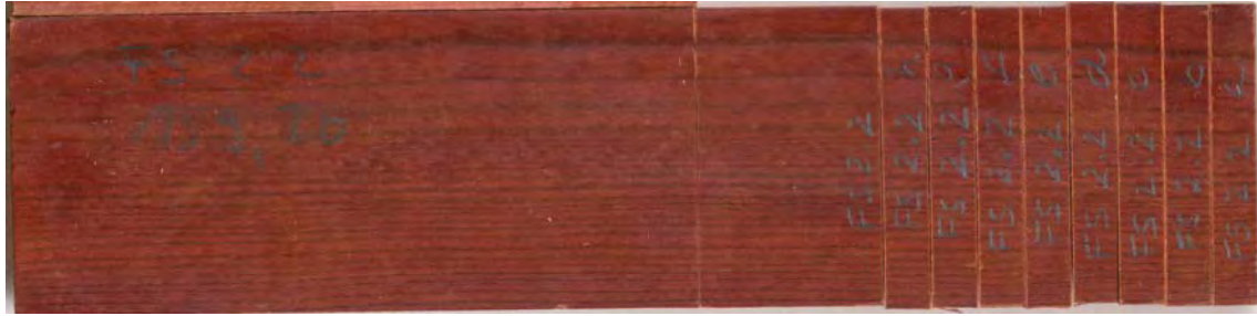
Abbildung 111: Hitzebehandelter Fichten-Prüfkörper der BFH (Fichte-Walsrode) nach Paraffin-Vollzell-Tränkung; Prüfkörper ist unvollständig durchfärbt
