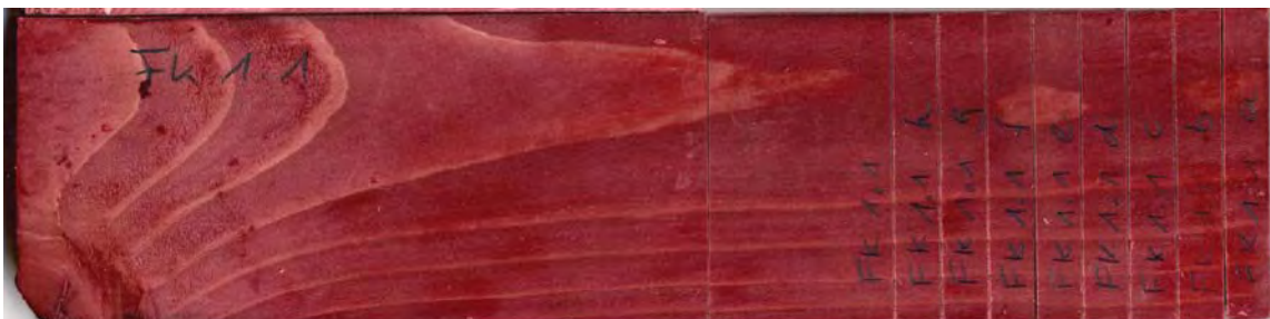
Abbildung 117: Fichten-Prüfkörper der BFH (Fichte-Walsrode-Kern) nach Paraffin-Vollzell-Tränkung; Prüfkörper ist unvollständig durchfärbt
