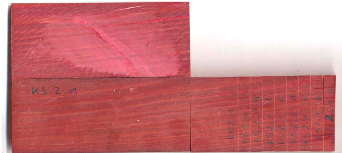
Abbildung 78: Kiefernsplint-Prüfkörper nach Paraffin-Vollzell-Tränkung; Prüfkörper ist vollständig und homogen durchtränkt
