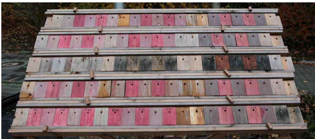
Abbildung 144: Prüfkörper nach dreimonatiger Bewitterung, die Hälfte der Prüfkörper ist mit unbewitterter Unterseite nach außen gedreht, um die Verfärbung/Entfärbung der bewitterten Oberflächen zu verdeutlichen
