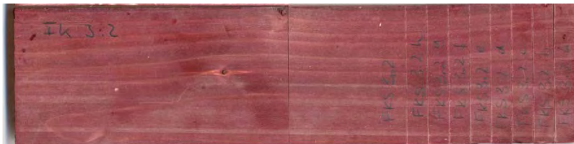
Abbildung 113: Fichten-Prüfkörper der BFH (Fichte-Walsrode-Kern) nach Paraffin-Vollzell-Tränkung; Prüfkörper ist unvollständig durchfärbt
