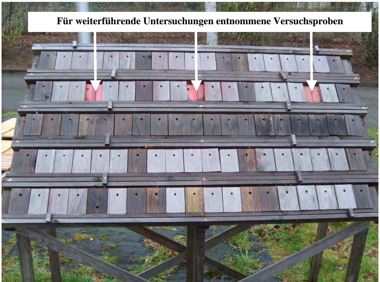
Abbildung 158: Versuchsproben nach 20 monatiger Bewitterungsdauer
