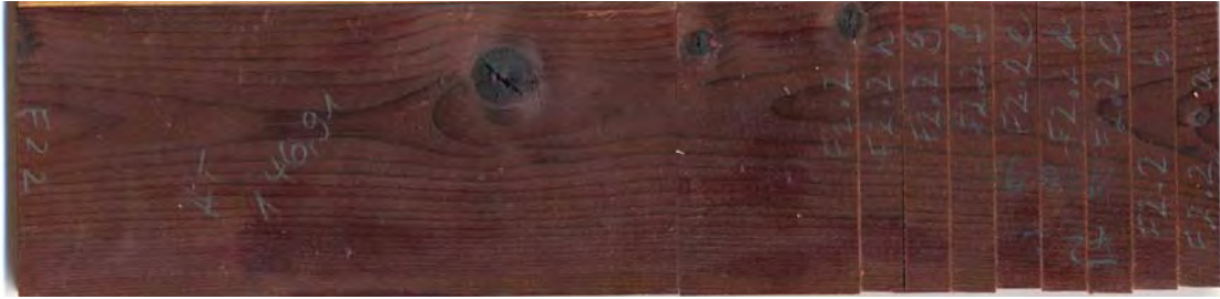
Abbildung 92: Hitzebehandelter Fichten-Prüfkörper der Steinbrücke & Berninghausen GmbH nach Paraffin-Vollzell-Tränkung; Prüfkörper ist unvollständig durchfärbt
