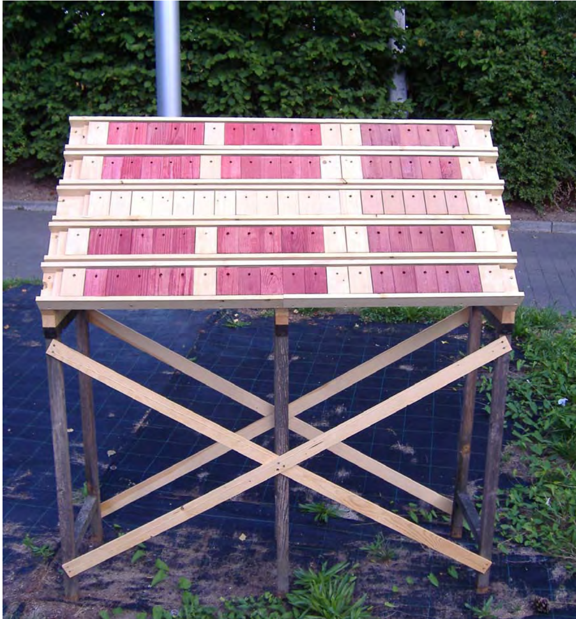
Abbildung 139: Aufbau der Bewitterungsversuche. Neigung der exponierten Prüfkörper-Fläche um 45°.
