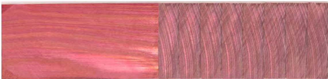
Abbildung 97: Fichten-Prüfkörper der BFH (Fichte-CZ/A) nach Paraffin-Vollzell-Tränkung – axiale Betrachtung der Durchfärbung; Prüfkörper ist vollständig durchfärbt
