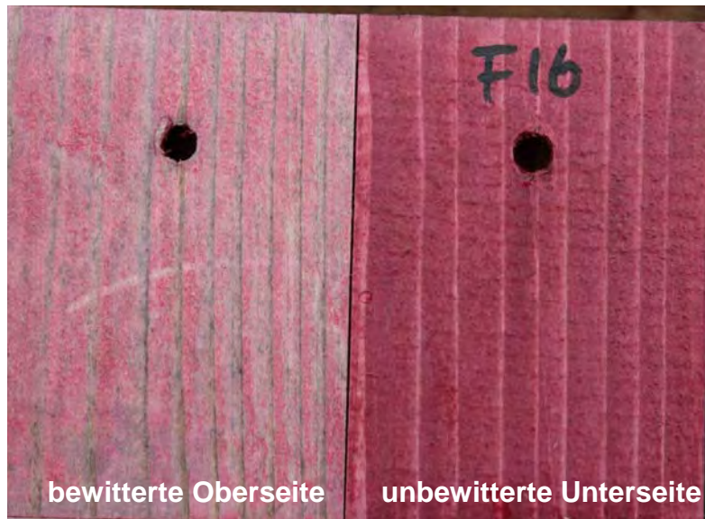
Abbildung 147: Prüfkörper nach dreimonatiger Bewitterung; wachsimprägnierte Fichtenprüfkörper
