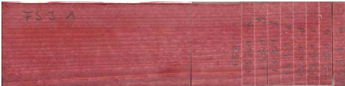
Abbildung 105: Fichten-Prüfkörper der BFH (Fichte-Walsrode) nach Paraffin-Vollzell-Tränkung; Prüfkörper ist unvollständig durchfärbt
