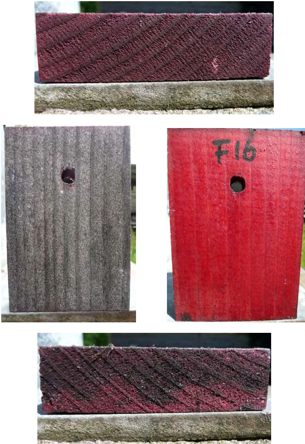
Abbildung 170: Wachsbehandelter Fichtenprüfkörper F16 nach 3 Jahren Exposition – Decklage; oberes Bild: Hirnfläche - Kopf, Mitte links: Frontseite, Mitte rechts: Rückseite, unteres Bild: Hirnfläche – Fuß
