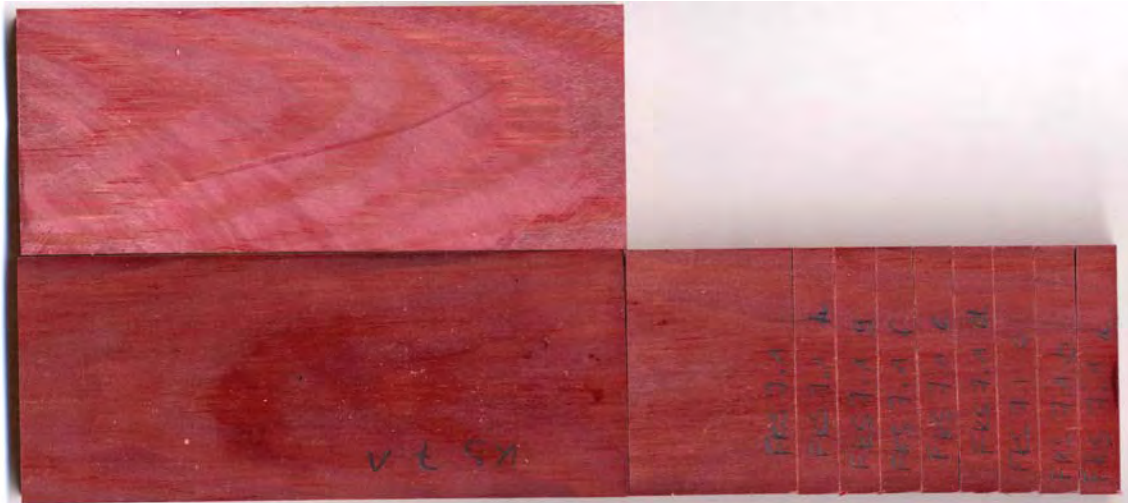
Abbildung 80: Kiefernslint-Prüfkörper nach Paraffin-Vollzell-Tränkung; Prüfkörper ist vollständig und homogen durchtränkt
