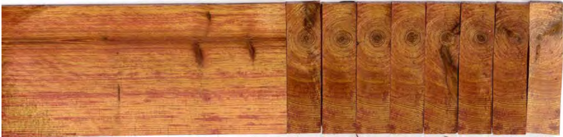
Abbildung 85: Hitzebehandelter Fichten-Prüfkörper der Steinbrügge & Berninghausen GmbH nach Paraffin-Vollzell-Tränkung – axiale Betrachtung der Durchfärbung; Prüfkörper ist unvollständig durchfärbt
