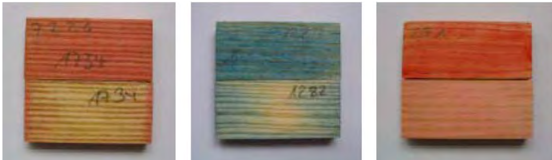
Abbildung 18: Prüfkörper mit Füllstoff 5, Eindringtiefe 2 mm (links), Prüfkörper mit Füllstoff 1, Eindringtiefe 18 mm (Mitte) , Prüfkörper mit Füllstoff 10, Eindringtiefe 25 mm (rechts)
