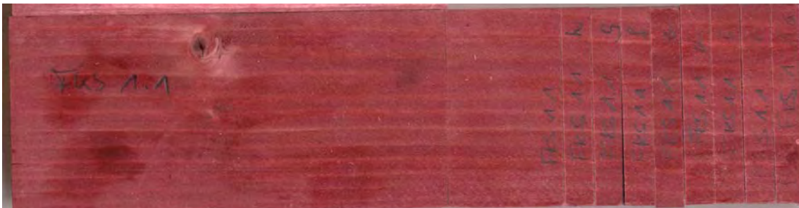
Abbildung 99: Fichten-Prüfkörper der BFH (Fichte-CZ/A) nach Paraffin-Vollzell-Tränkung; Prüfkörper ist unvollständig durchfärbt
