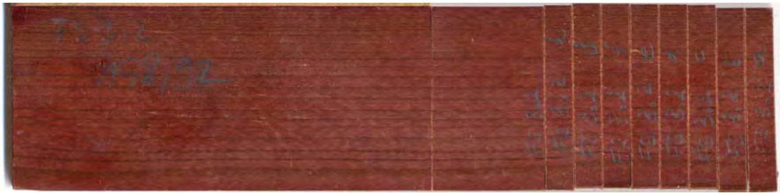
Abbildung 107: Hitzebehandelter Fichten-Prüfkörper der BFH (Fichte-Walsrode) nach Paraffin-Vollzell-Tränkung; Prüfkörper ist unvollständig durchfärbt
