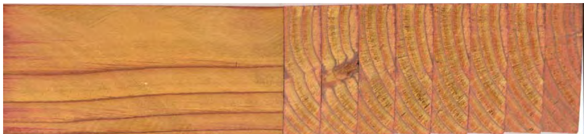
Abbildung 124: Hitzebehandelter Fichten-Prüfkörper der BFH (Fichte-Walsrode-Kern) nach Paraffin-Vollzell-Tränkung- axiale Betrachtung der Durchfärbung; Prüfkörper ist unvollständig durchfärbt
