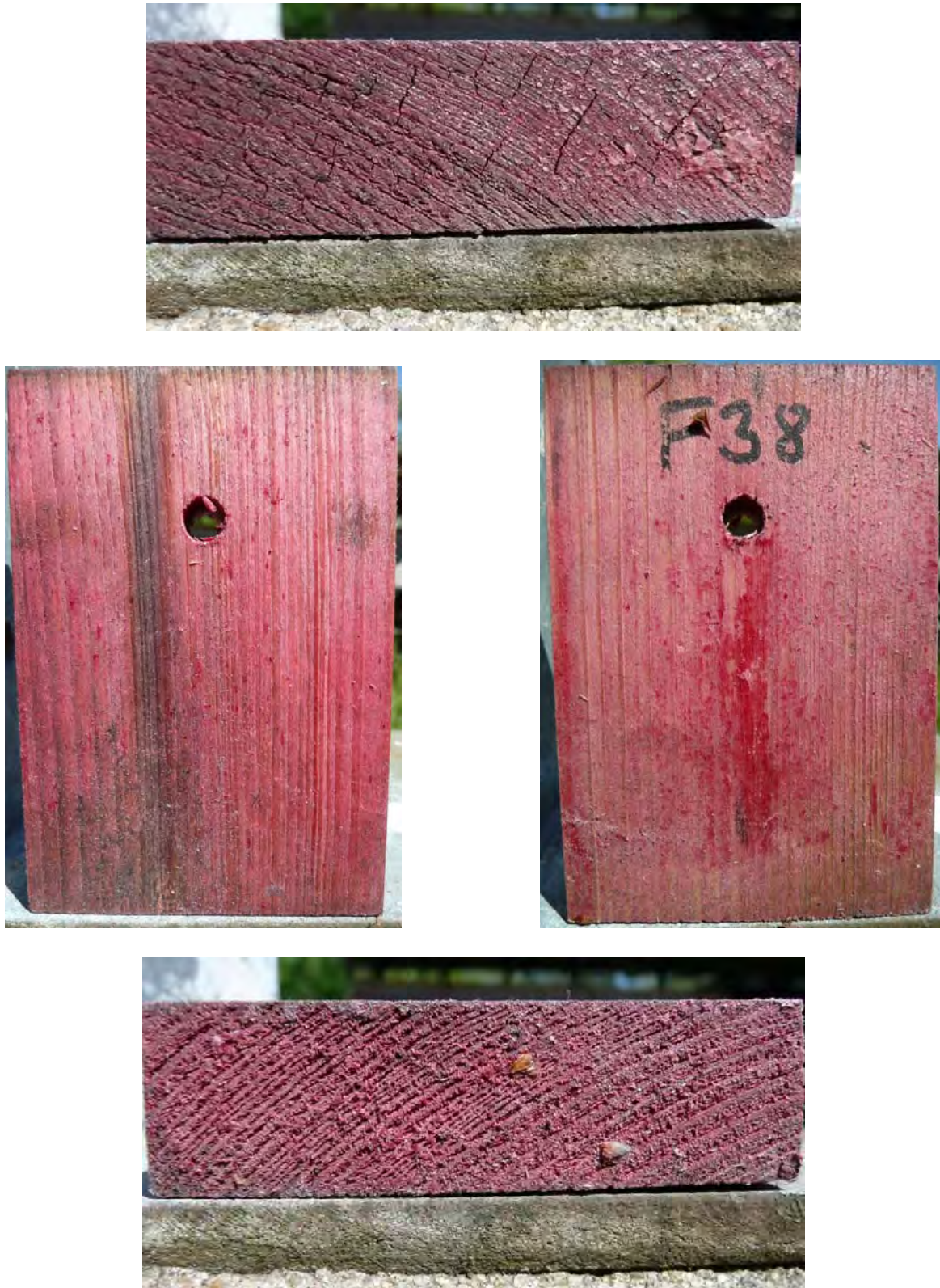
Abbildung 171: Wachsbehandelter Fichtenprüfkörper F38 nach 3 Jahren Exposition – Unterlage; oberes Bild: Hirnfläche - Kopf, Mitte links: Frontseite, Mitte rechts: Rückseite, unteres Bild: Hirnfläche – Fuß
