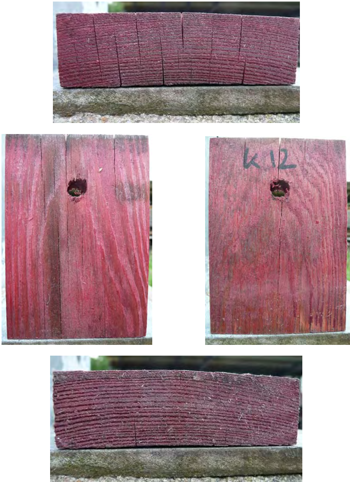
Abbildung 176: Gerissener, wachsbehandelter Kiefernprüfkörper K12 nach 3 Jahren Exposition – Unterlage; oberes Bild: Hirnfläche - Kopf, Mitte links: Frontseite, Mitte rechts: Rückseite, unteres Bild: Hirnfläche – Fuß
