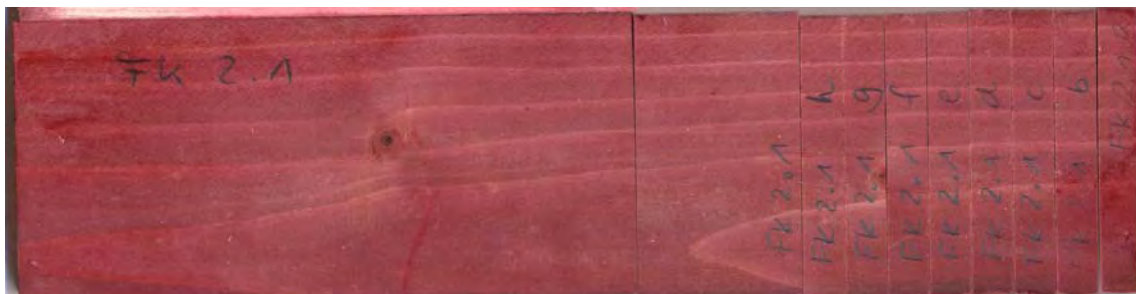
Abbildung 121: Fichten-Prüfkörper der BFH (Fichte-Walsrode-Kern) nach Paraffin-Vollzell-Tränkung; Prüfkörper ist unvollständig durchfärbt
