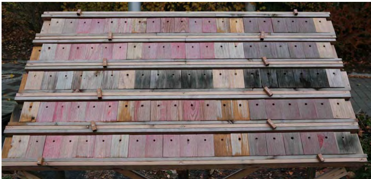
Abbildung 143: Prüfkörper nach dreimonatiger Bewitterung, Oberflächen sind stark verblasst und verfärbt
