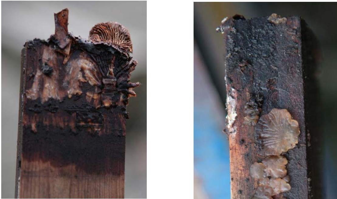
Abbildung 32: Fruchtkörper an Plattentyp-Nr. 298 (links) und -Nr. 290 (rechts)
