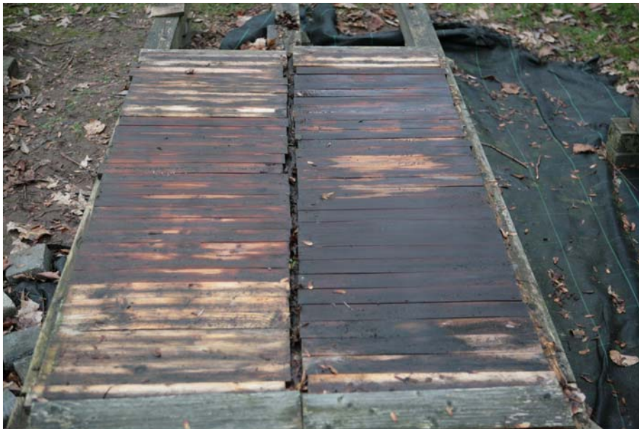
Abbildung 31: Unterlage der Laborplatten nach 24-monatiger Freibewitterung
