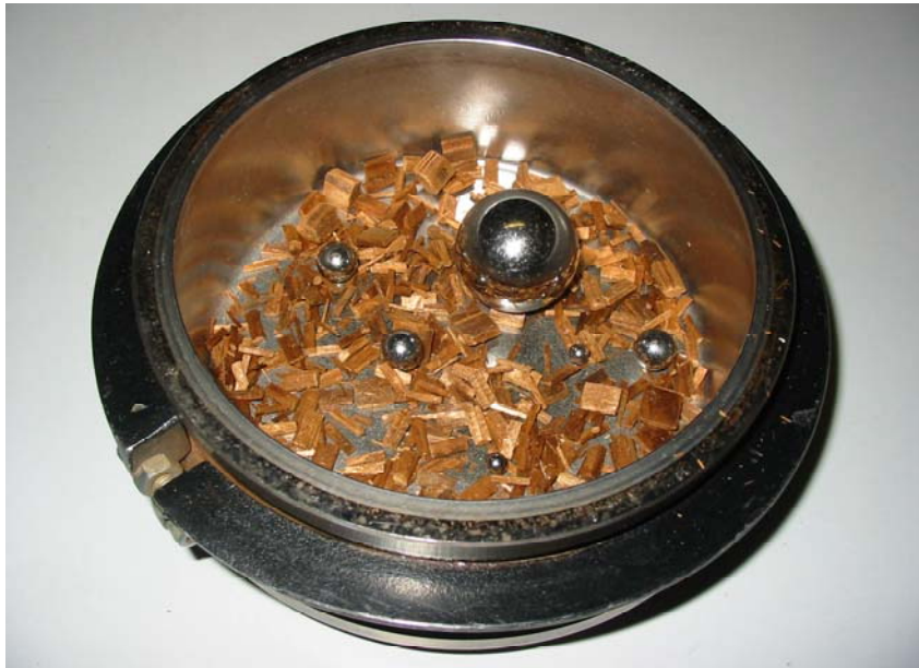
Abbildung 2: HEMI-Prüfung: Edelstahlschlagbecher samt Fragmenten und Stahlkugeln
