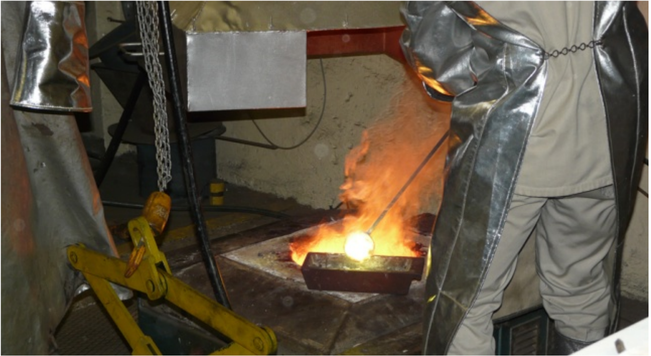
Abb. oben: Hier ist das Abschöpfen von überflüssiger Schmelze zu beobachten.
