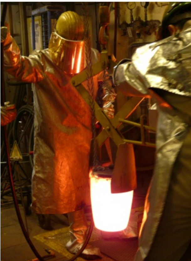
Mittels einer schweren Hebeeinrichtung wurde der Schmelztigel sehr vorsichtig aus dem Ofen herausgehoben.
