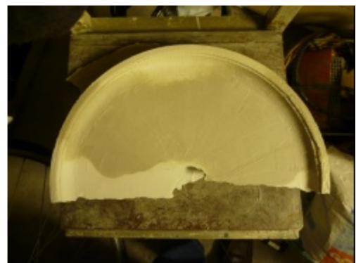
...aber das bisher verwendete Material nicht! Es hielt selbst leichteste Belastungsproben nicht aus. Schon der Transport wäre damit in Frage gestellt gewesen. Das Risiko war damit zu hoch
