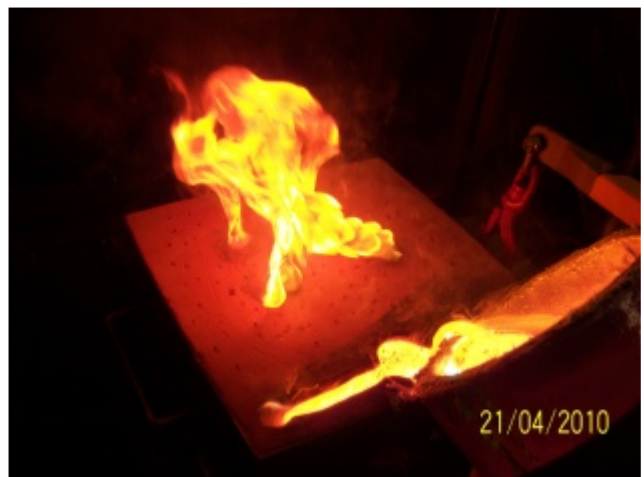
Die obige Abbildung rechts zeigt den Augenblick, als das glühend heiße Metall in die Form gefüllt wurde und unten, wie die brennende Luft entweicht
