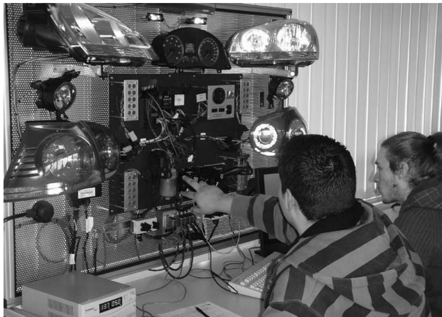
Abb. 1: An der Laborwand wird an einem Polo Tagfahrlicht nachgerüstet
