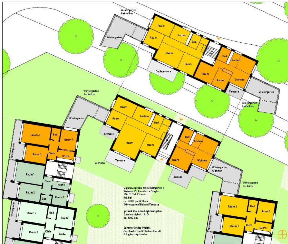
Grundriszvariante exemplarisch 1 Erdgeschoss + 2. Obergeschoss M. 1:200
