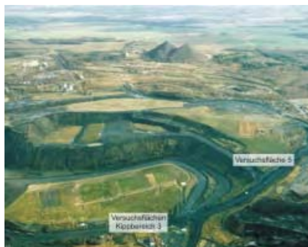
Abb. 6-12a (links) Tagebau Lichtenberg 1991 im Revier Ronneburg nach kompletter Einstellung des Betriebes. Das Tagebaurestloch war zu diesem Zeitpunkt 160 m tief, 900 m breit und 1200 m lang.
