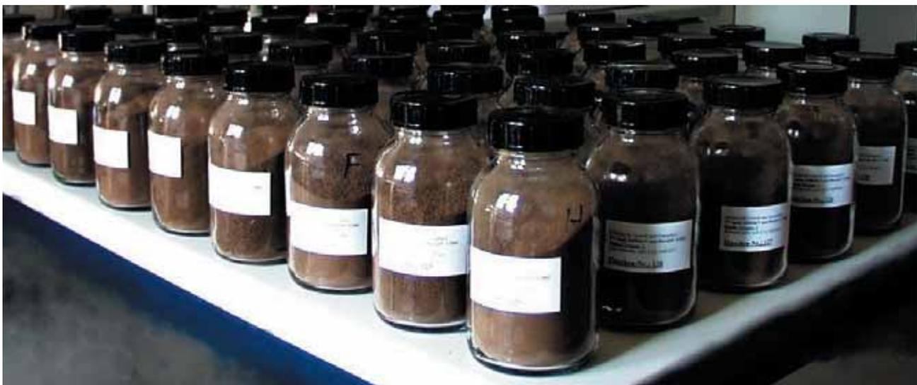
*Bodenproben für die Laborvergleichsuntersuchung*
