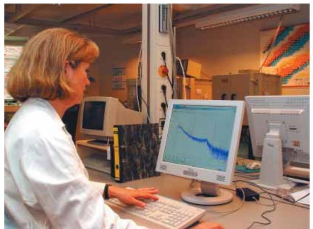
*Messplatz für die Gammasppektrometrie*
