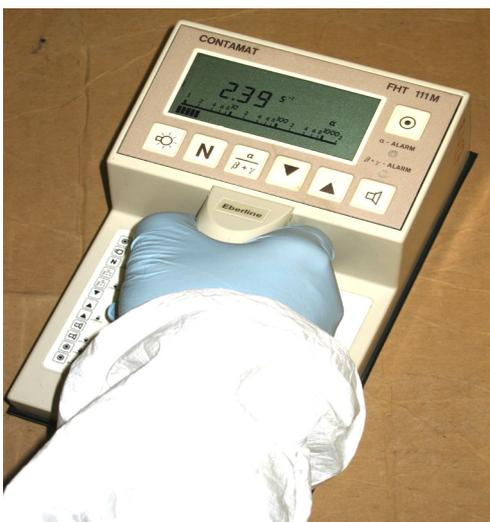
Abbildung 17: Kontamat zur Messung von Radioaktivität auf Oberflächen
