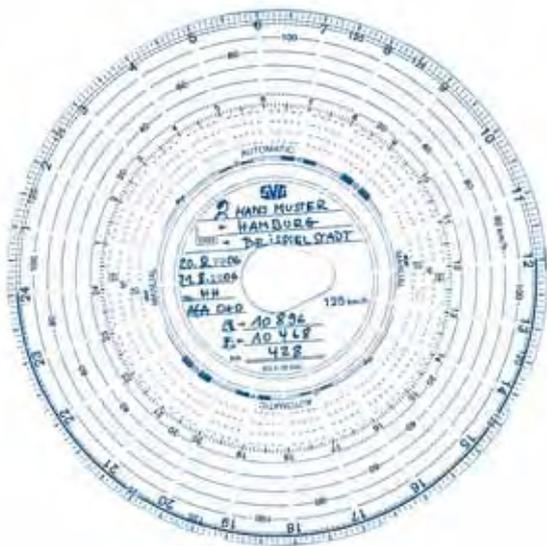
Die analoge Diagrammscheibe zeichnet Geschwindigkeit, gefahrene Kilometer, Lenk-, Arbeits- und Ruhezeiten auf
