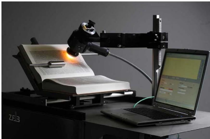
Abb. 4: Das *NIR-Paperrating*-Analysegerät des *ZFB* bestimmt den Erhaltungszustand von Papier zerstörungsfrei und schnell mittels Nah-Infrarot-Technologie.
