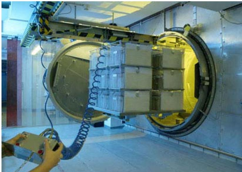
Abb. 2: Die mit Papier bestückten Körbe der Massenentsäuerungsanlage des ZFB in Leipzig werden zur Tränkung in die Behandlungskammer eingefahren.
