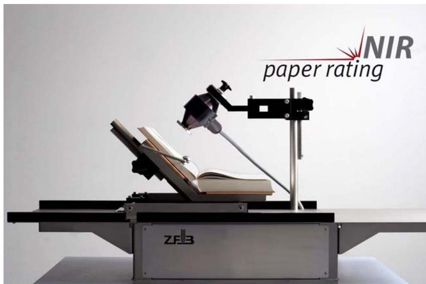
Das *NIR-Paperrating*-Analysegerät bestimmt den Erhaltungszustand von Papier, zerstörungsfrei und schnell mittels Nah-Infrarot-Technologie.
