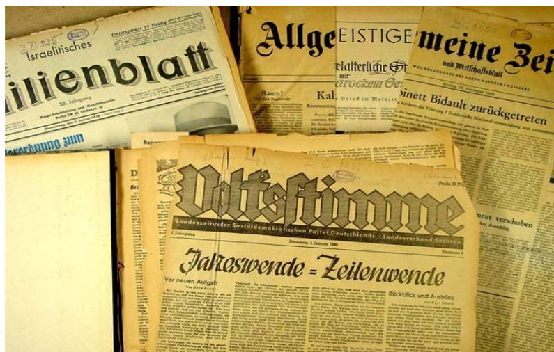
Abb. 1: Saure Zeitungsbände, die kurz vor dem Zerfall stehen. In diesem Fall kommt eine konservierende Entsäuerung zu spät. Lediglich durch eine kostenintensivere Restaurierung wie dem Papierstabilisieren können diese Originale noch für die Nachwelt erhalten werden.
