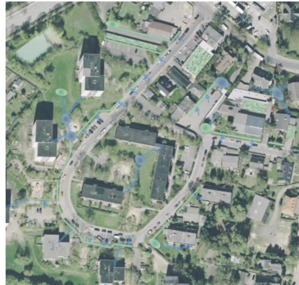
Skizze eines Regenwassernutzungskonzepts im Einzugsgebiet der Düpenau
