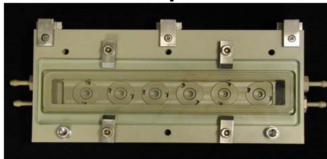
fluiddynamische Belastung (überströmende Flüssigkeit), patentiert, AG Pörtner
