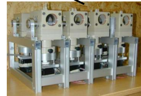
mechanische Belastung (Normalkräfte, Rollen, Gleiten, Scherung), AG Schilling/Morlock
