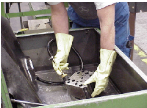
Photo 5a+b: Typische Reinigungsarbeiten bei der Instandhaltung: in einem Reinigungsbad und an einem Waschtisch.
