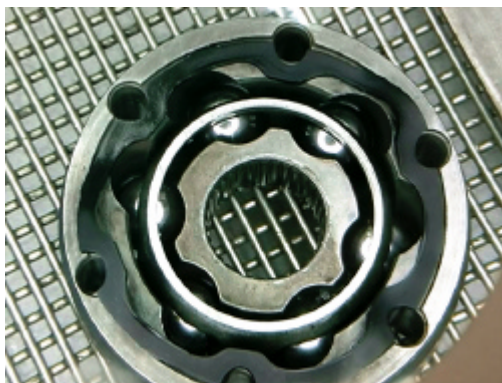
Photo 4a+b: Abreinigung von Schmierfett mit Molybdändisulfid ( \text{MoS}_2 ) bei Teilen der Antriebsgelenke (Auto) mit einer esterbasierten Mikroemulsion.
