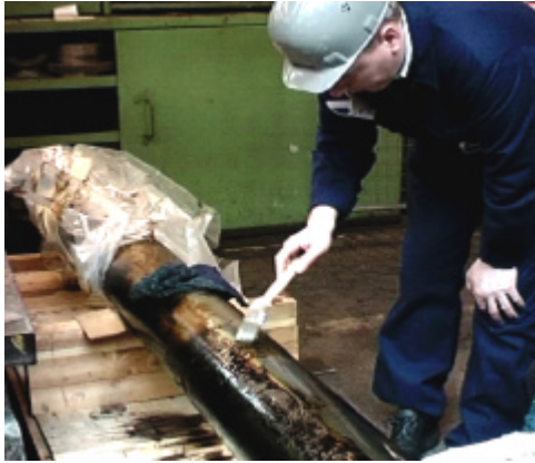
Photo 6: Abreinigung der Tectyl-Beschichtung von einer Schiffsantriebswelle auf der Werft
