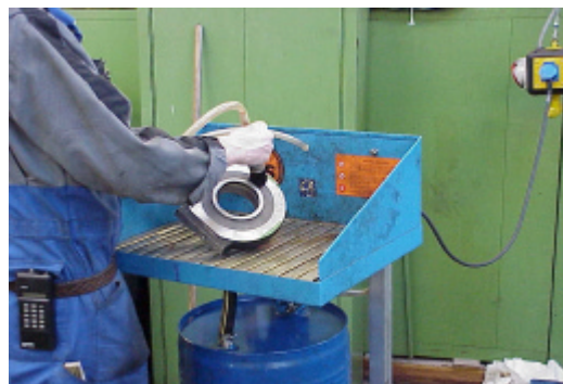
Photo 5a+b: Typische Reinigungsarbeiten bei der Instandhaltung: in einem Reinigungsbad und an einem Waschtisch.
