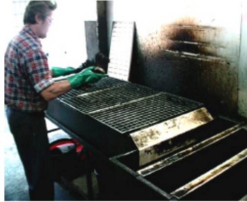
Photo 7: Manuelle Reinigung von Schildern, Entfernung einer Lack-/Bitumenschicht
