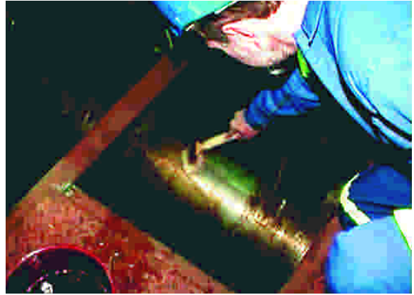
Entfernung der Schutzbeschichtung von einer Schiffswelle bei den Thyssen Nordseewerken in Emden
