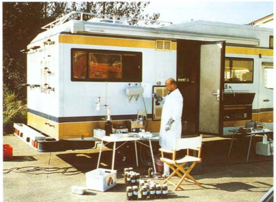
Abb.3.6 Vort-Ort-Schnellanalytik mit mobilem GC/MS-Analysegerät (MM-1)
