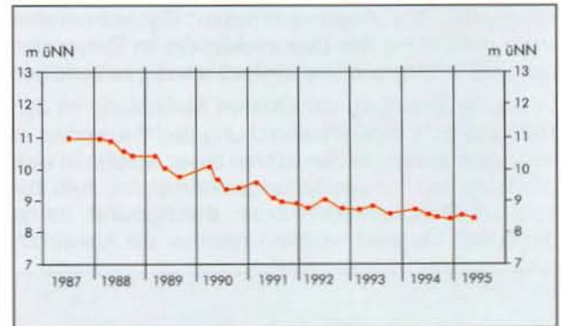
Abb. 10.3: Stauwasserspiegelgang am Pegel 31.1 von 1987 bis 1995
