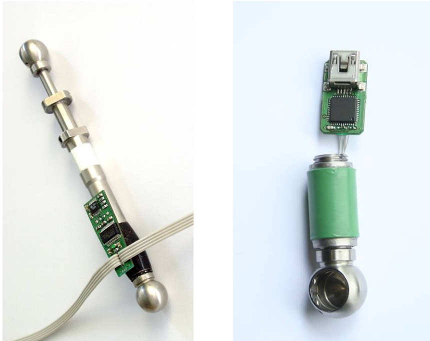
Abb. 18: Messschaltung für Pfostenverbinder am Distraktor (links) und verkleinerte Messschaltung am optimierten Sensor (rechts)
