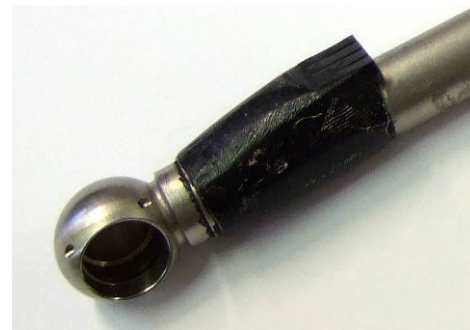
Abb. 15: Verkapselung der Sensorbrücke für den Fixateur externe
