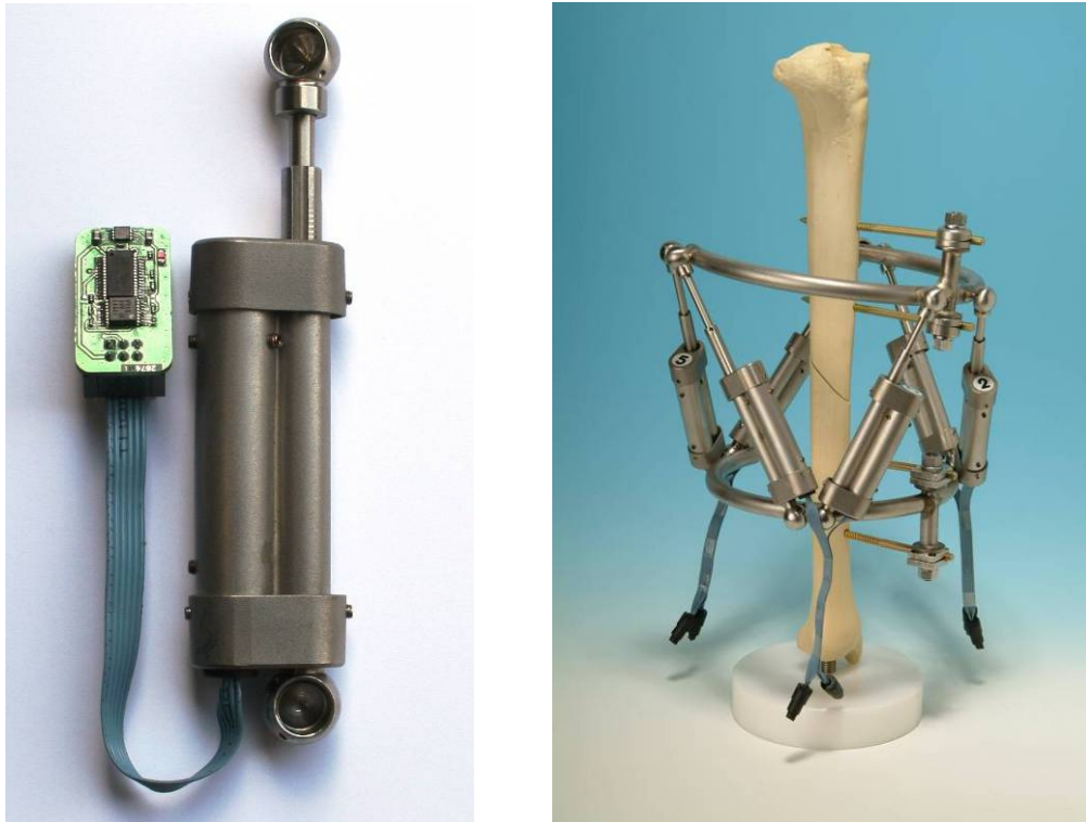
Abb. 27: Motordistraktor mit Steuerelektronik (links) Montierter Motorhexapode (rechts)
