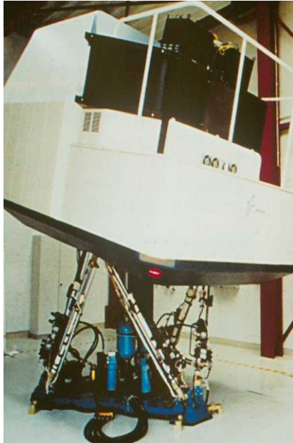
Abb. 2: Hexapod Kinematik im Flugsimulator (SIMTEC, Braunschweig)
