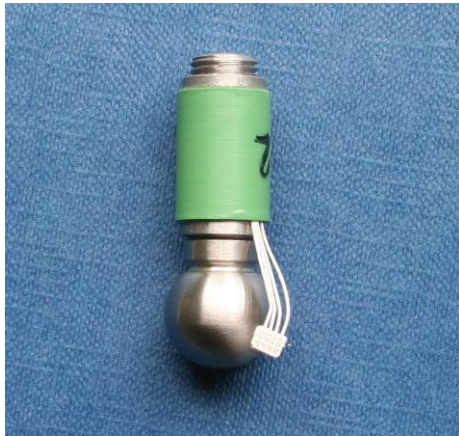
Abb. 16: Verkapselung des Sensors mit PEEK-Rohr
