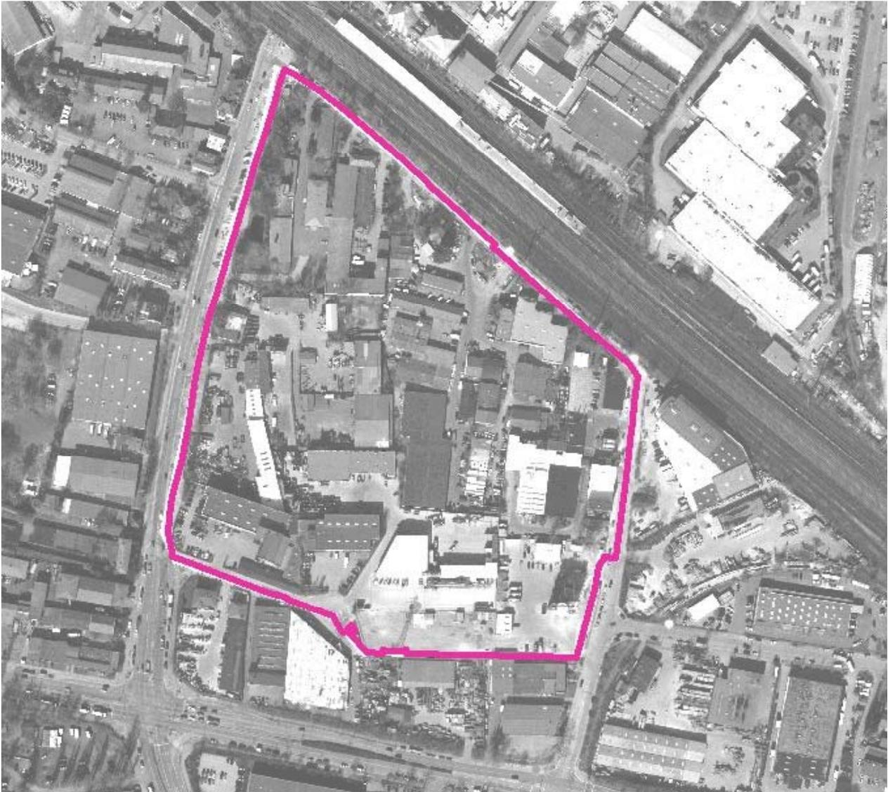
Abb. 1: Luftbild vom Industriegebiet Eidelstedt südlich der S-Bahnlinie Hamb.-Altona – Pinneberg mit Verlauf der Dichtwand
