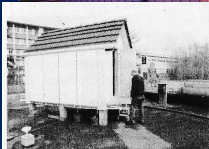
Bild 1. An einem kleinen Versuchsgebäude messen Schweizer Forscher von Eawag und Empa bei realen Wetterbedingungen im Freien wie der Regen Biozide aus Fassaden auswäscht. (© Eawag) GWF-WA 149 (2008, 10): 726-727
