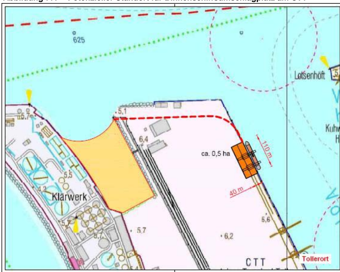
Abbildung 77: Potenzieller Standort für Binnenschiffsumschlagplatz am CTT
