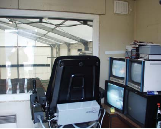
Abb. 5 Steuerstand des ferngesteuerten Baggers
