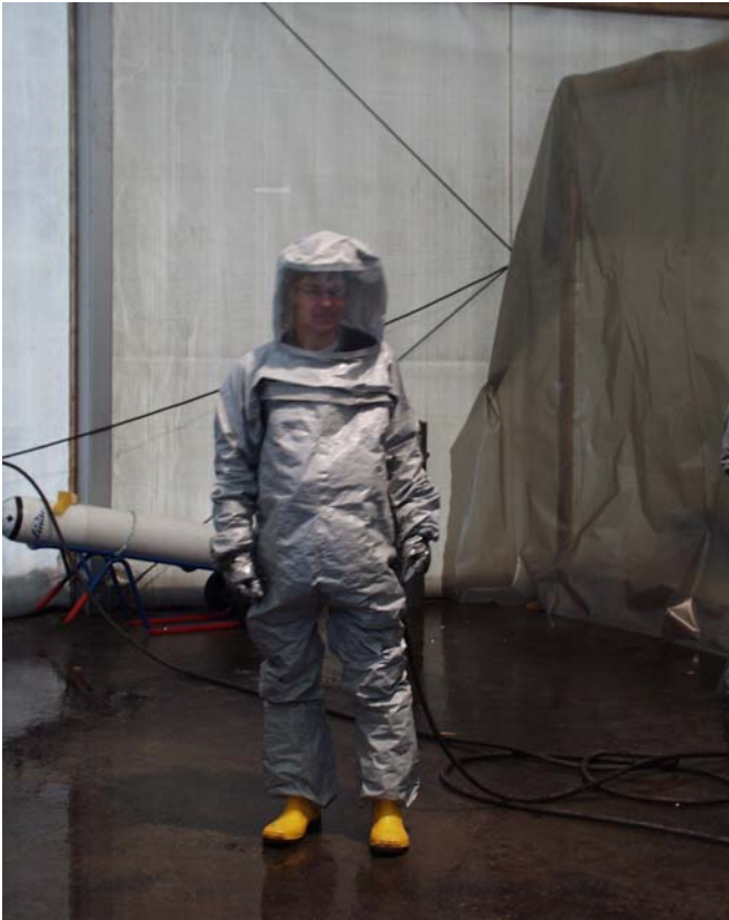
Abb. 9 Vollschutzanzug mit Pressluftversorgung
