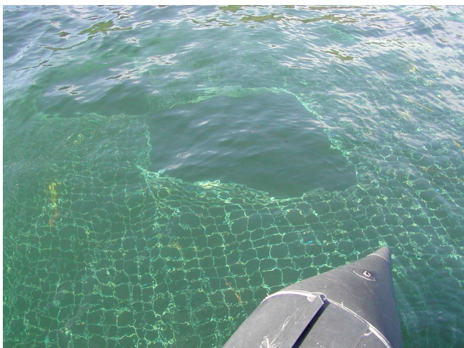
Abb. 5: Das eingesetzte Bariumsulfatnetz hinter dem Heck des Schlauchboots. Deutlich ist eine der Sollbruchstellen zu erkennen, die ermöglichen sollten, verfangene Tiere schnell zu befreien.
