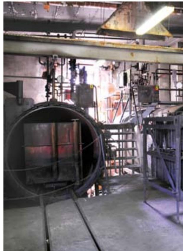
Kammfabrik, Vulkanisieren der in Zinnfolien gepressten Kämmе
