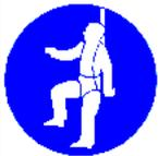
Das Ausbringen und Auftakeln der Gangway ist eine Arbeit, bei der auf Grund noch fehlender oder unzureichender Geländer eine Absturzgefahr besteht. Deshalb ist bei dieser Tätigkeit grundsätzlich der Sicherheitsgurt (xy) zu tragen. Zur Sicherung sind die gekennzeichneten Anschlagpunkte zu benutzen.
