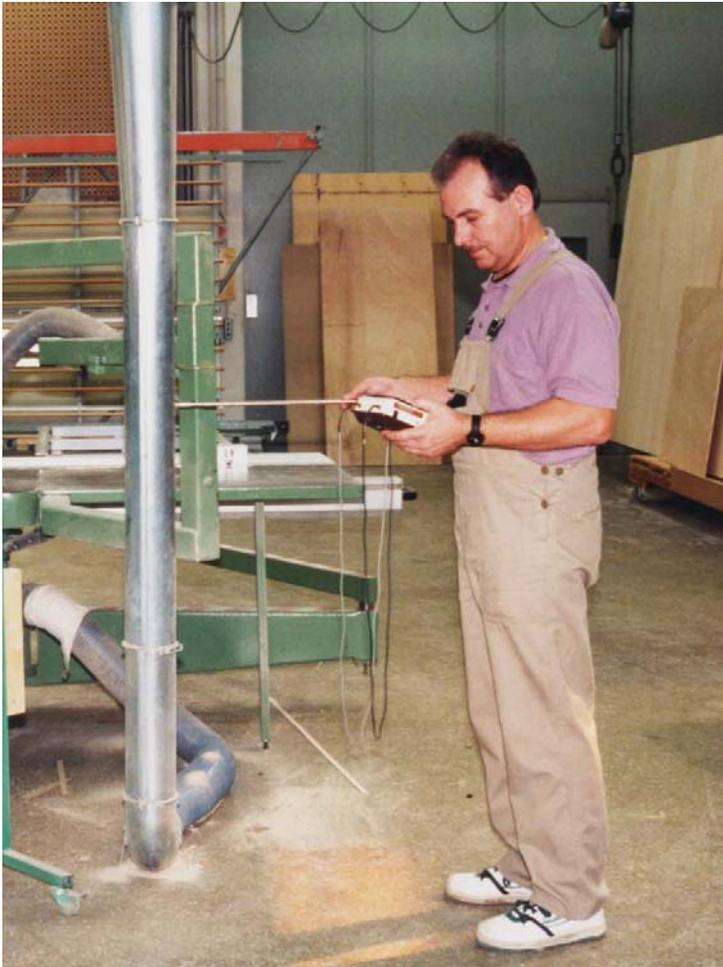
Messen der Strömungsgeschwindigkeit im Rohr!
