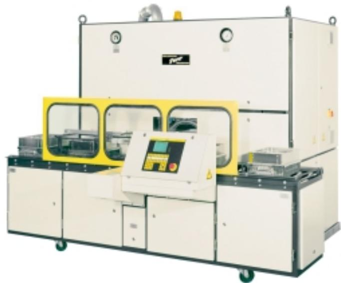
Anlage zur Oberflächenreinigung von Kleinteilen
