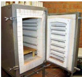
Beim Glattbrand müssen die Werkstücke im Brennofen so aufgestellt werden, dass beim Ausräumen keine Verletzungsgefahren entstehen.
