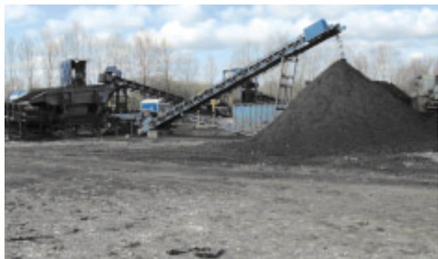
**Anlage zur Trennung von Boden- und Auffüllungsbestandteilen**
